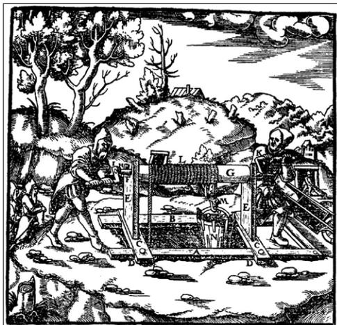
Fig. 4 – Estrazione di minerali o acqua da un pozzo di miniera di epoca rinascimentale. L’argano è molto simile a quello ancora usato 350 anni dopo nella miniera di petrolio di Vallezza, in provincia di Parma, illustrato in Fig. 5 (G. Agricola, *De Re Metallica*, Basilea, 1556).
