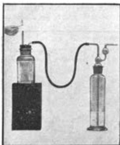
beweist sicher und deutlich, dass in ein mit Benzin gefülltes Fass eine Flamme oder ein Blitz hineinschlagen kann, ohne eine Entzündung oder gar eine Explosion hervorzurufen.
